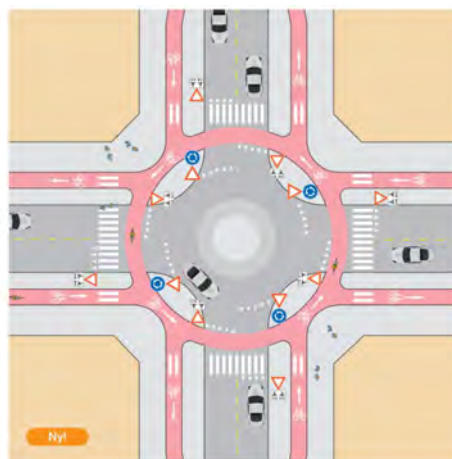
Figur 23: Arealtilpasset rundkjøring med beskyttet sykkelfelt adskilt fra øvrige kjørefelt.
