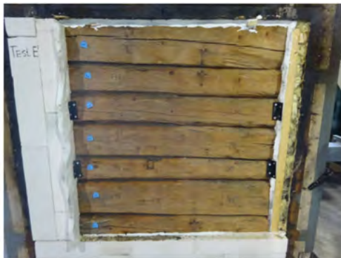
Foto 14 Ueksponert side av tømmervegg E før test.
