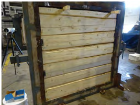
Foto 1 Ueksponert side av tømmervegg A før test.
