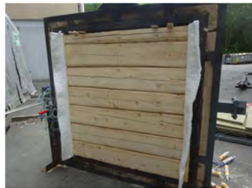
Foto 8 Brannekspontert side av tømmervegg C før test.
