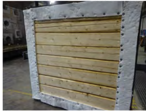
Foto 5 Brannekspontert side av tømmervegg B før test.
