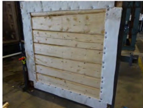
Foto 2 Branneksponert side av tømmervegg A før test.
