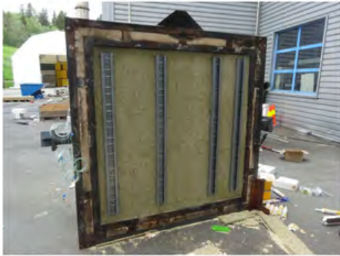
Foto 11 Branneksponert side av tømmervegg D før test.
