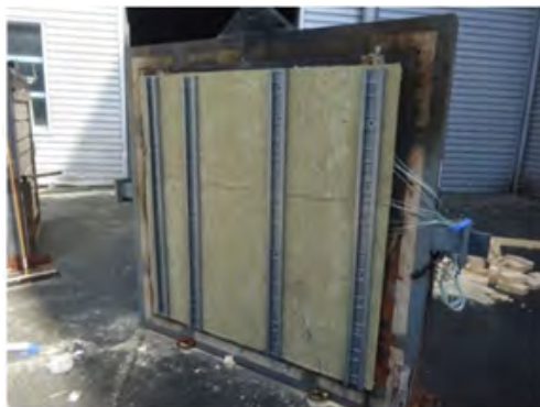
Foto 7 Uekspontert side av tømmervegg C før test.
