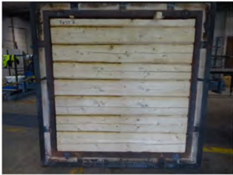
Foto 4 Uekspontert side av tømmervegg B før test.
