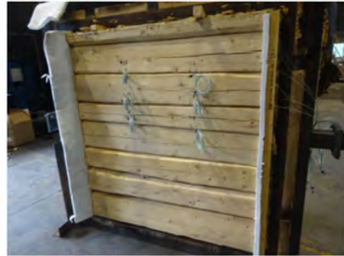
Foto 12 Ueksponert side av tømmervegg D før test.
