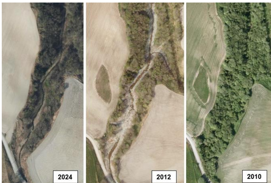
Figur 108. Om lag 300 meter av Ristelva (Høstadbekken) ble rassikret, steinsatt og kanalisert mellom 2011 og 2012, og mistet dermed en del av sin naturtilstand, som var status i 2010 og tidligere år. Den vandringshindrende kulverten i figur 105 ble lagt ned i samme tidsrom. Flyfotoserie: https://kart.finn.no/
