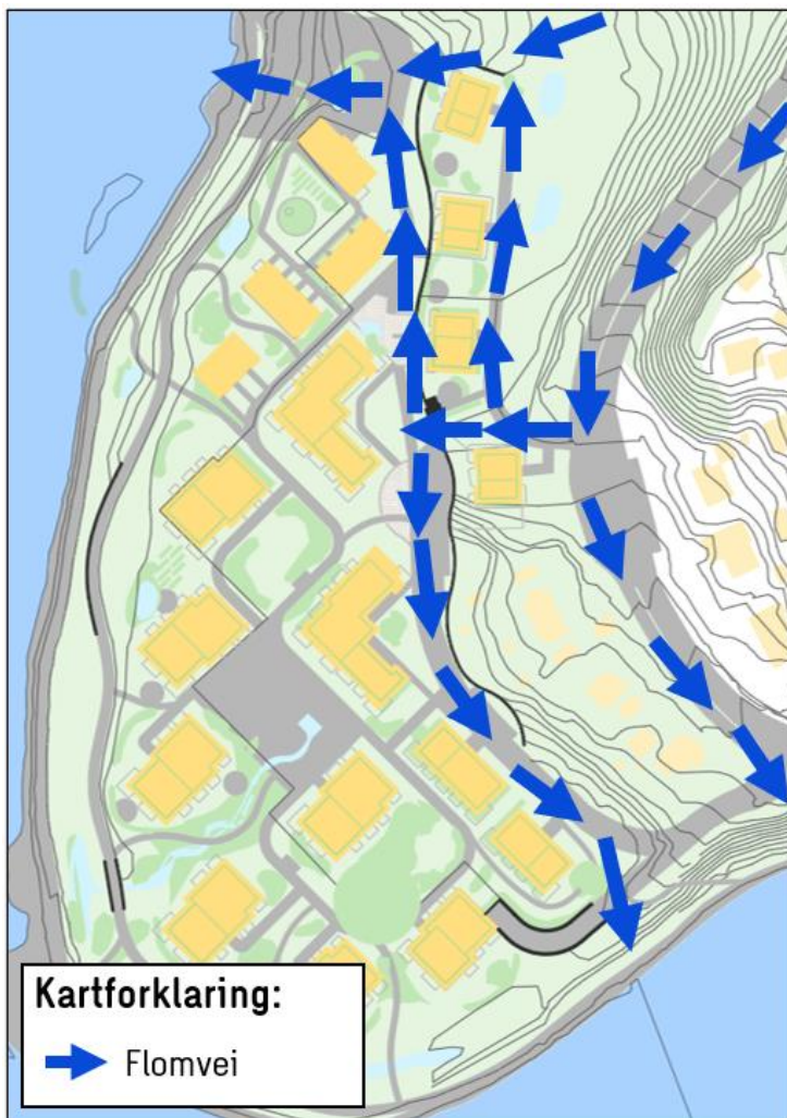
Figur 12 En grov oversikt over potensielle flomveier tilknyttet planområdet i en fremtidig situasjon
