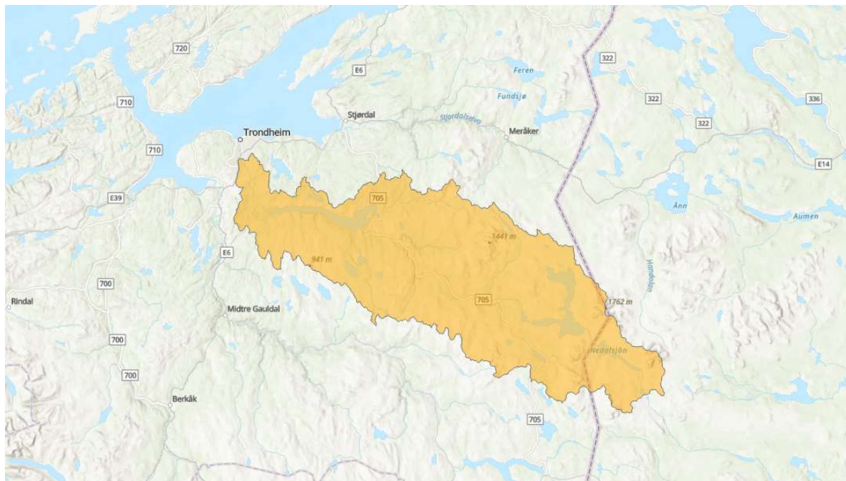
Figur 1-4: Kart over nedbørfeltet til Nidelva. Feltet er beregnet via SCALGO.
