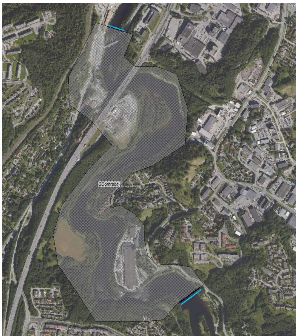
Figur 4-2: Kart som viser beregningsnettet, plassering av grensebetingelsene og avgrensning av analyseområdet for den hydrauliske modellen.
