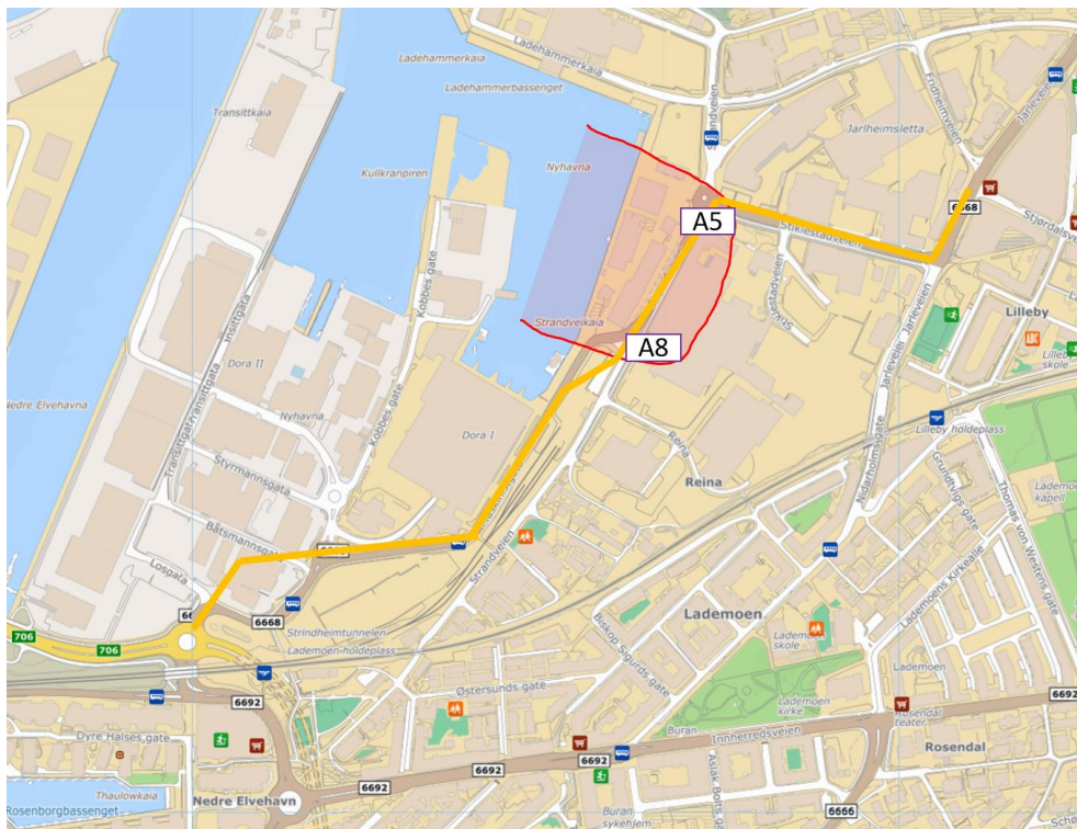
Figur 5 Grunnundersøkelser i Strandveien mellom A5 og A8 (tegnet inn) indikerer at det kan være sprøbruddmateriale i bakken. Derfor er det et aktsomhetsområde på denne strekningen og ut mot fjorden (omtrentlig tegnet inn med rødt).
