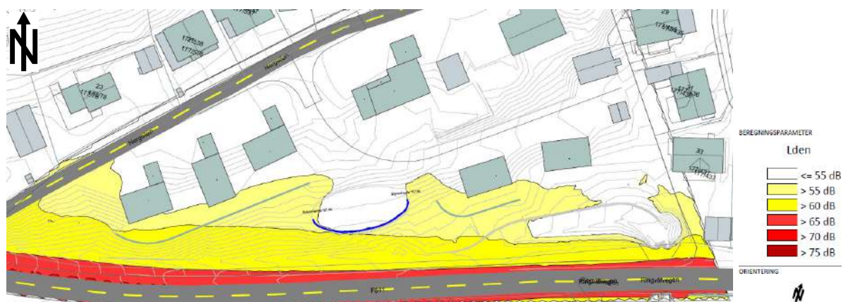
Figur 4 – Utsnitt fra tegning X004: Støynivå L_{den} på uteareal, beregnet i 1.5 m høyde. Planlagt skjerm i blått.
