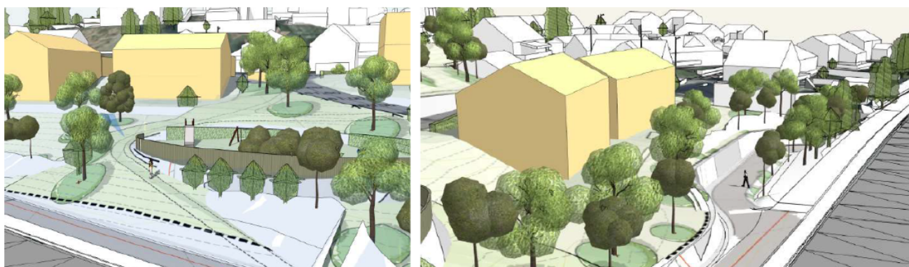
Illustrasjonene viser at det er store høydeforskjeller på tomta i forhold til anleggelse av snarvei og også omfang av støttemurer.
