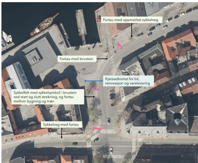
Figur 40: Sykkeltilbud langs Olav Tryggvasons gate, Munkegata og Fjordgata forbi Ravnkloa. Systemskifter markert med rosa linjer.
