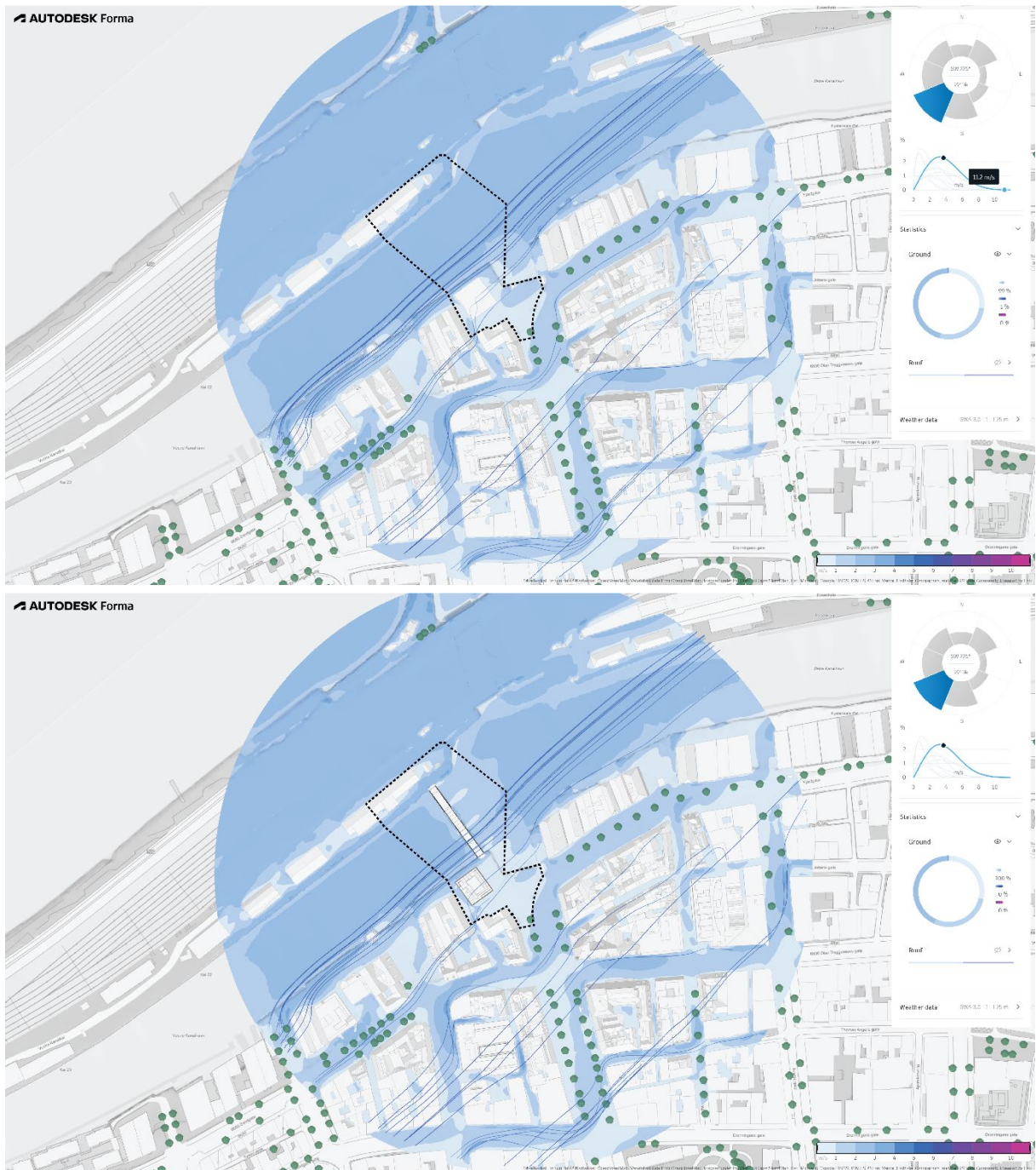
Figur 2 Eksisterende situasjon øverst, ny situasjon under. Vindsimulering med vindretning fra sørvest. I ca. 25% av tiden er vindhastigheten rundt 2 m/s, dvs. svak vind. Brua vil bremse vinden i kanalen. Det nye bygget vil gi noe mindre vind på østsiden.
