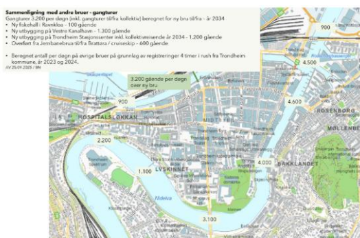
Figur 23: Beregnet antall gangturer per døgn over ny bru i Ravnkloa i framtidig situasjon og beregnet antall turer i dagens situasjon på øvrige bruer rundt Midtbyen
