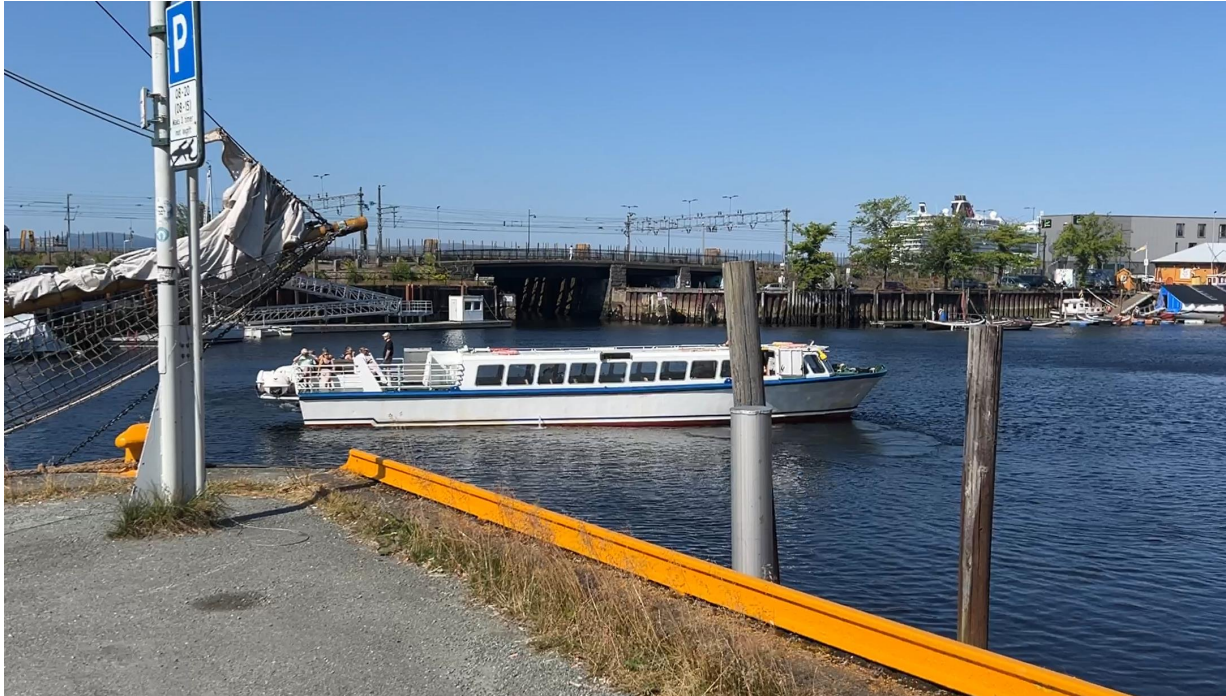
Figur 8 MS Nidarholm ved avgang fra Ravnkloa. Bildet viser båten i det den er ferdig med akterovermanøveren og er klar til å sette fart forover for å gå ut Ravnkloløpet i bakgrunnen. Dette fartøyet har ikke baugthruster. Brua vil starte ca. 3 m til venstre for den gule pullerten og følge retningen til den gule kaiskinna.
