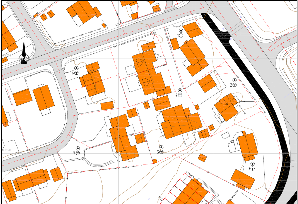
Figur 9: Utsnitt fra borplan for geoteknisk- og miljøgeologisk undersøkelse. Planlagte borpunkter er vist med sorte sirkler. Kilde: Dr. Techn Olav Olsen AS tegning «Borplan», datert 29.06.2023.
