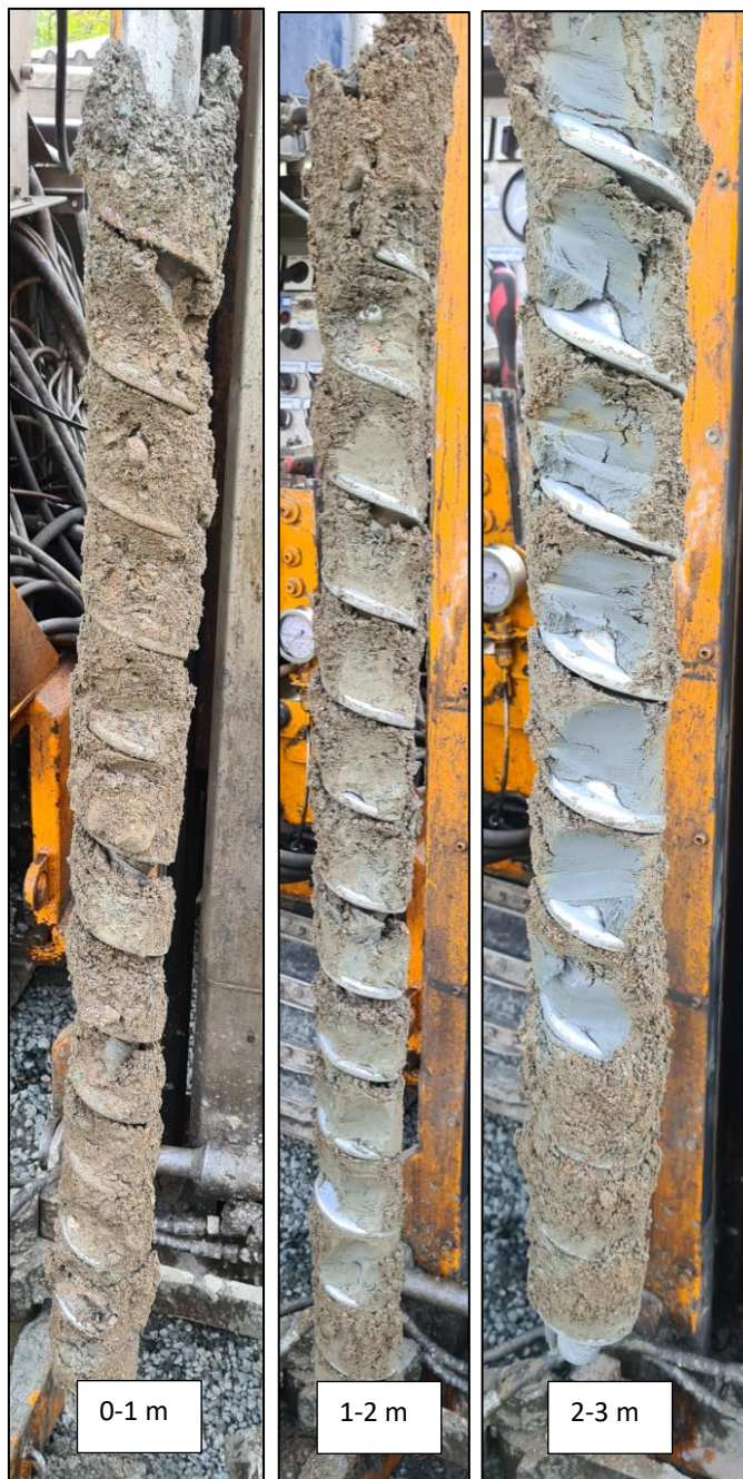
Figur 14: Masser i prøvepunkt SK6. Dybde 0-0,3 meter: sand og grus, 0,3-1 meter: leire, sand og grus, 1-2 meter: leire, antatt omrørt/oppfyllt, og 2-3 meter: antatt original leire.
