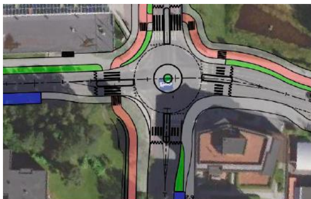
Vegtegninger med rundkjøring til venstre og signalregulert kryss med sykkelveg til høyre. Grått viser fortau, rosa viser sykkelveg, blått viser kollektivholdeplass og grønt viser rabatter.
