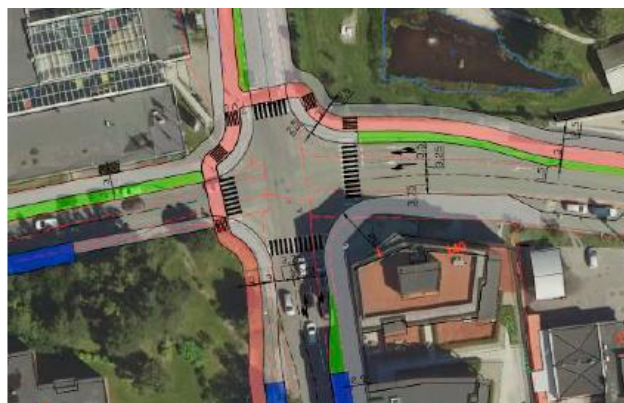
Vegtegninger med rundkjøring til venstre og signalregulert kryss med sykkelveg til høyre. Grått viser fortau, rosa viser sykkelveg, blått viser kollektivholdeplass og grønt viser rabatter.
