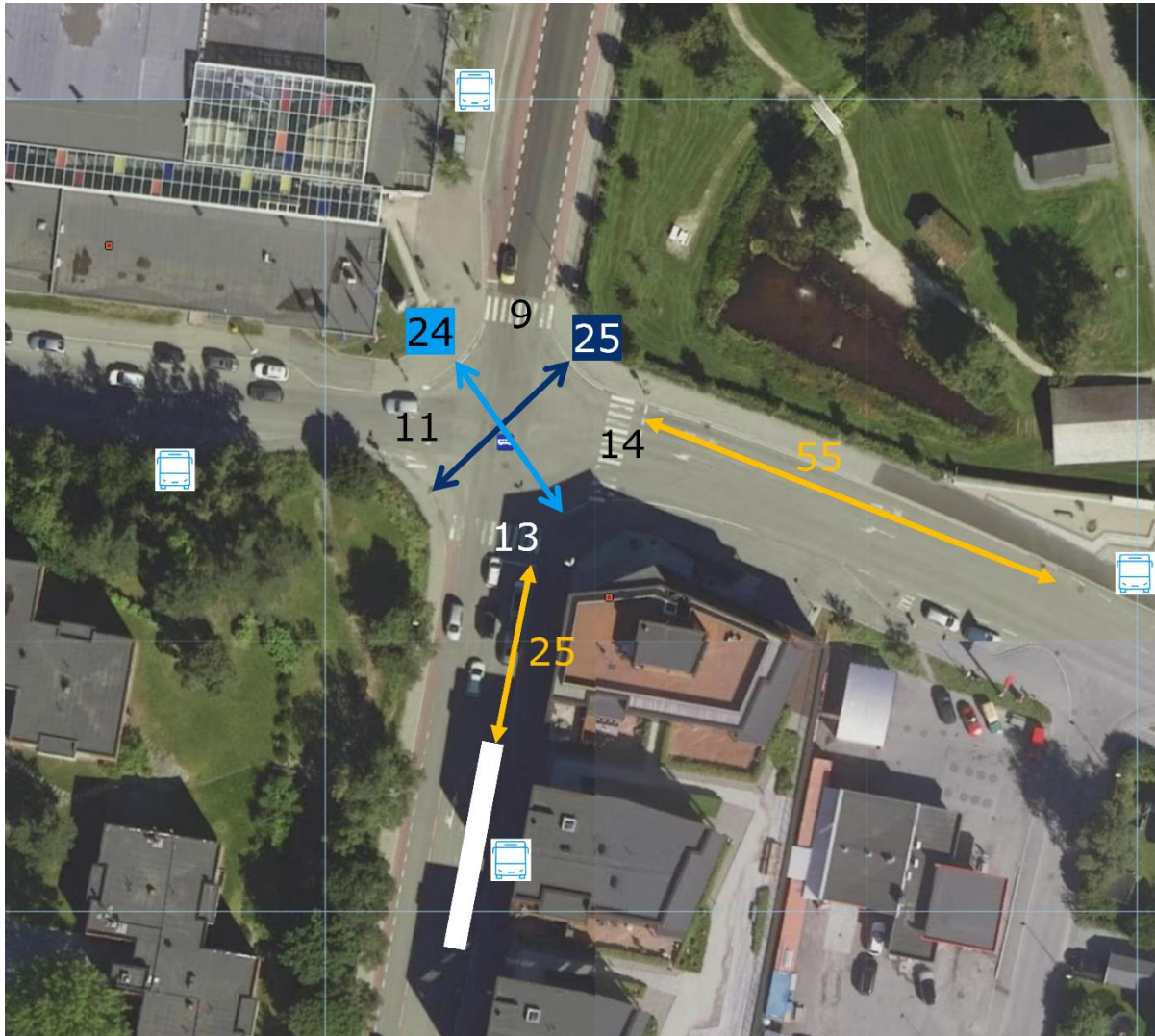
Figur 9 Kryssets geometri med lengder for gangfelt og kjørefelt (kartkilde: kart.finn.no)
