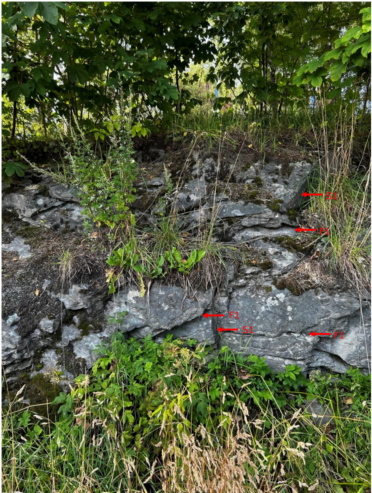
Figur 8: Tolkning av foliasjon og sprekkesett. S1 ser ut til å folde seg noe.
