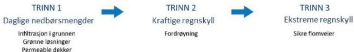
Figur 13 Tretrinnsmodellen for håndtering av overvann
