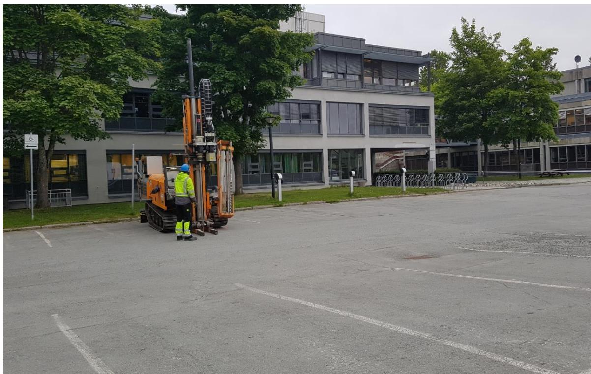
Figur 7: Prøvetaking ved hjelp av Multiconsults geotekniske borerigg.
