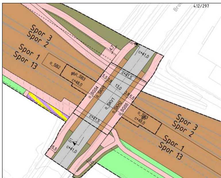
Figur Utsnitt av reguleringsplankartet som viser spor med spornummer, samt vertikalnivå 3 (Leangbrua) over vertikalnivå 2 (på grunnen) (COWI AS).
