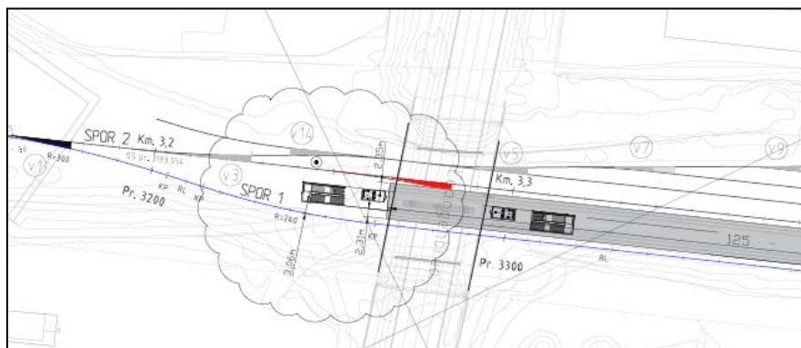
Figur Utsnitt fra sporplan som viser mulighet for etablering av vestre trappe- og heishus (COWI AS).
