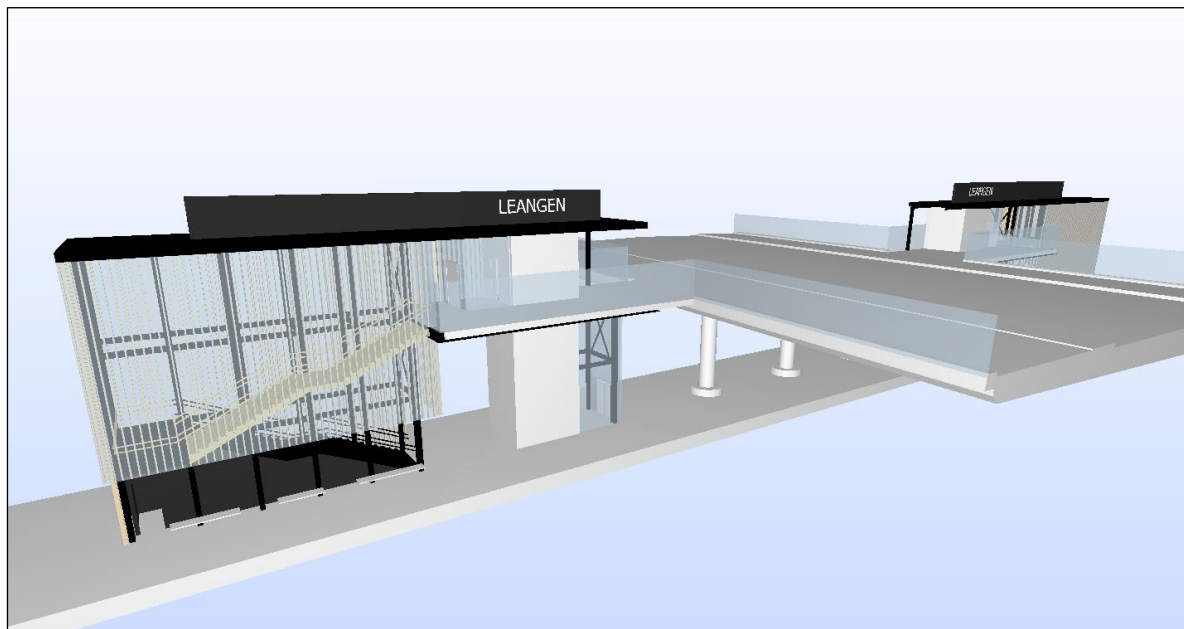
Figur 3 Illustrasjon som viser prinsipp for planlagte heis- og trapphus ved Leangbrua. Illustrasjon: PIR2 arkitekter.
