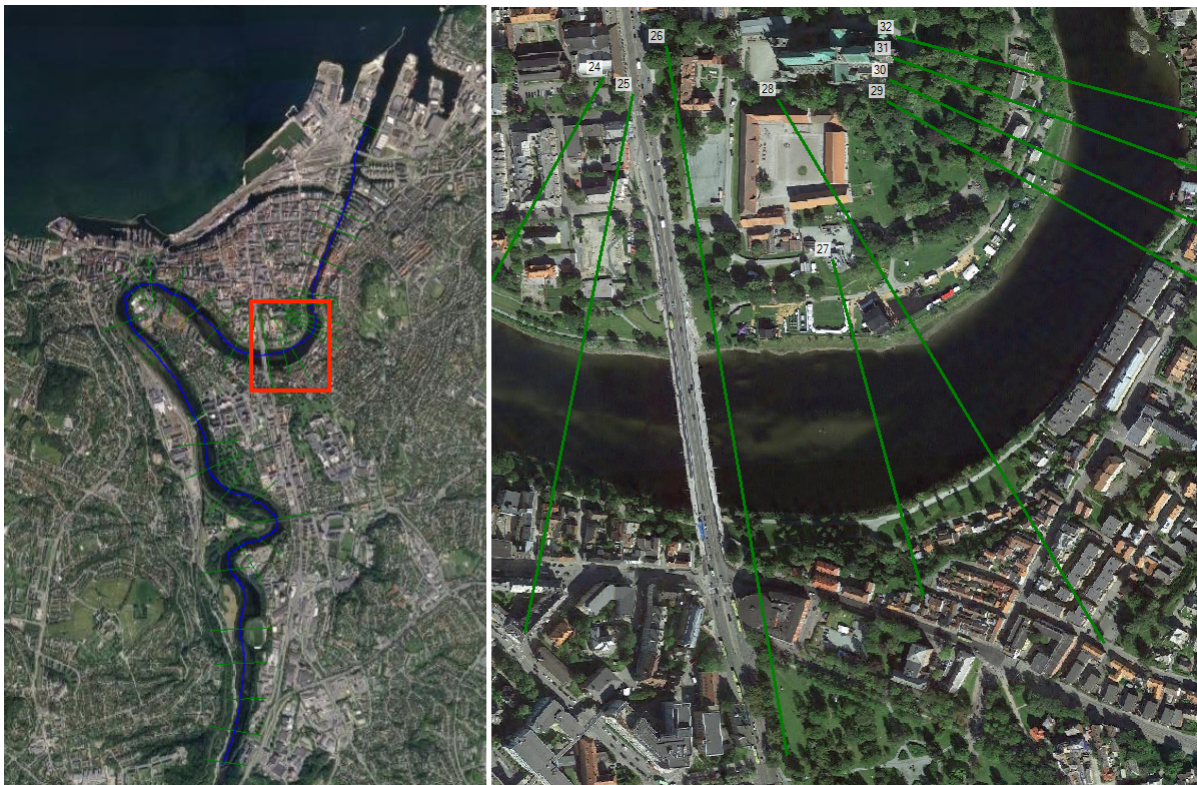
Figur 8 Oversikt over tverrprofiler i den hydrauliske modellen (/2/ fig. 4)
