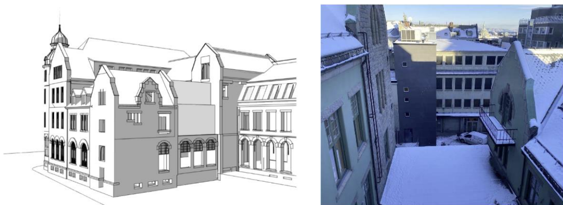
Figur 4-13 Til venstre: Nytt mindre bygningsvolum mot nordre fasade. Foto til høyre viser tidligere lysgård som bygges igjen. Tegning og foto: Erik Langdalen arkitektkontor AS
