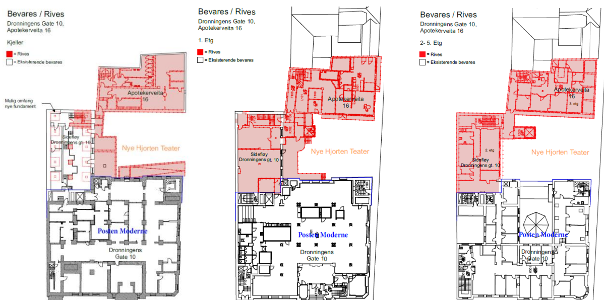
Figur 4-12 Illustrasjonene viser hva som må rives i Postgården. Kilde: Skibenes arkitekter AS
