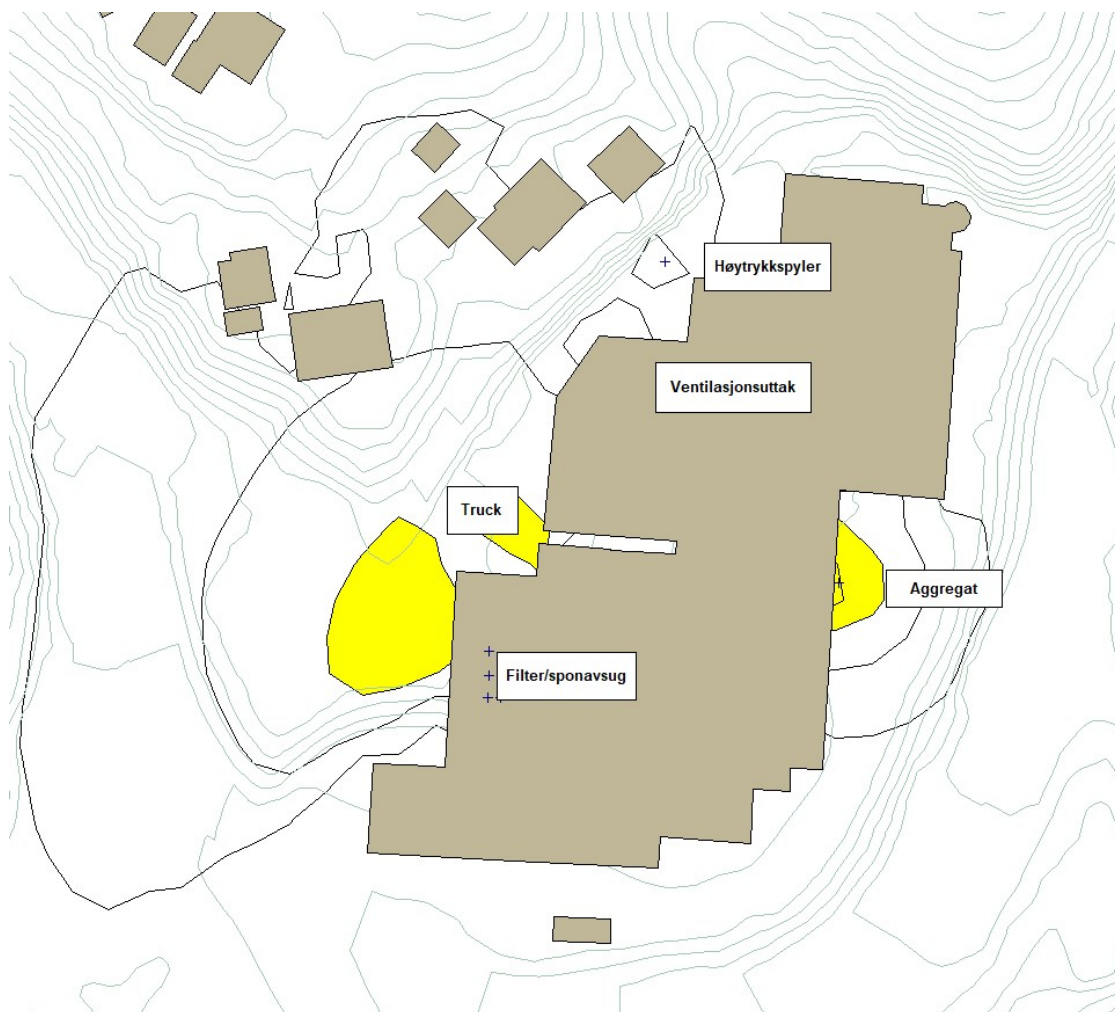
Figur 2. Støysonekart av området ved Forsøkslia 9, i 4 meters høyde. Gul sone, L_{den} 55-65 dB, rød sone, L_{den} > 65 dB. Støysoner for hver 5 dB er vist med svarte linjer.
