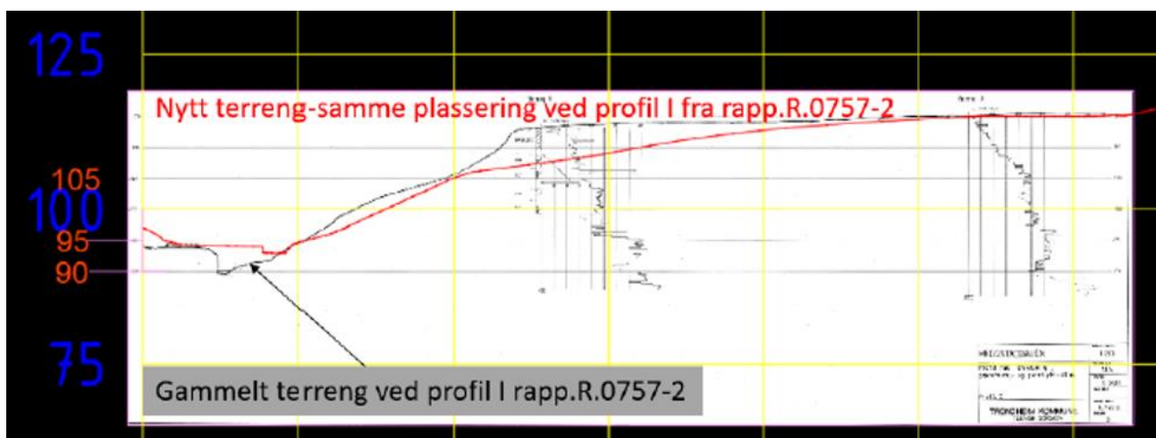
Figur 8: Dagens og gammelt terreng ved profil I fra rapport R.0757-2. Tidligere terrenginngrep og erosjonssikring har medført at dagens terreng viser en tydelig forbedring av områdestabiliteten.
