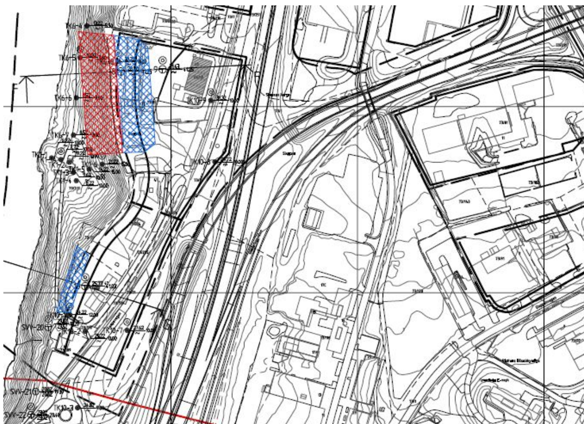
Figur 9: Utsnitt av tegning R1579-202, fra rapport R1579-3. Blå skravur - nedplanering med optil 5 meter. Rød skravur - nedplanering og utslaking av av skråningen
