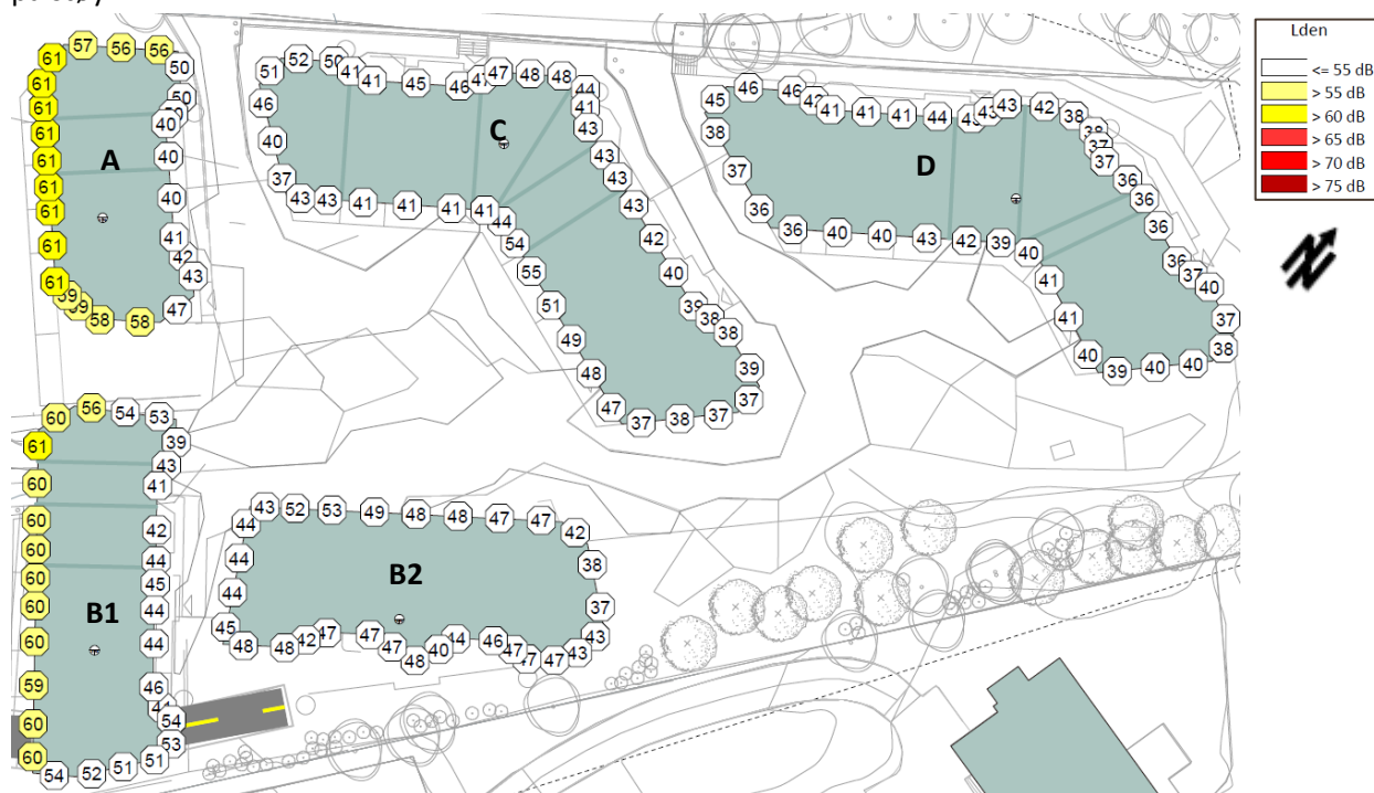
Figur 6 - Beregnet A-veid ekvivalent lydnivå for dag-kveld-natt, L_{den} . Sirklene viser det høyeste støynivået, L_{den} , i fasaden av alle etasjer.
