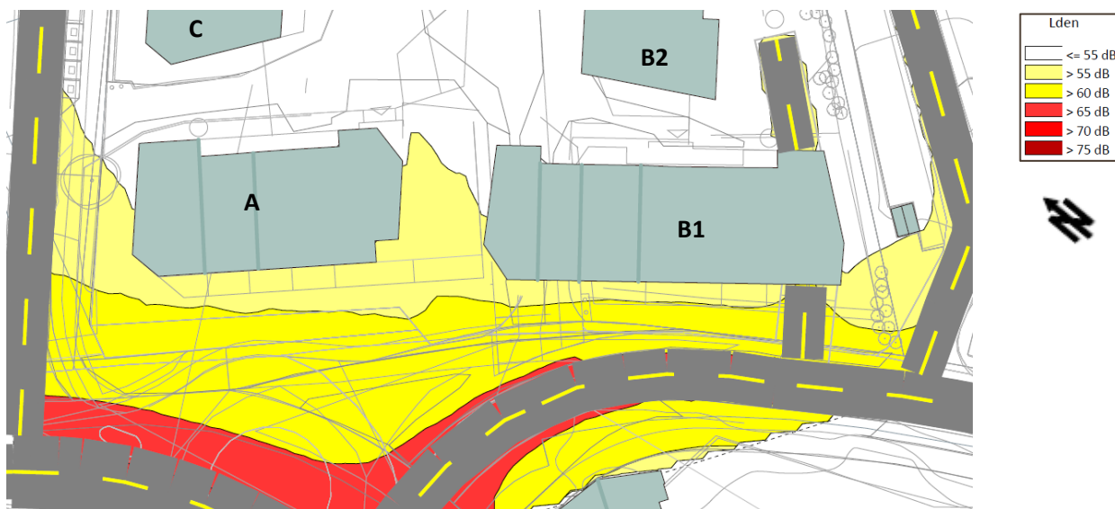
Figur 5 - Beregnet støynivå på uteareal, L_{den} , for veitrafikk. Beregningshøyde 1,5 m over terreng.
