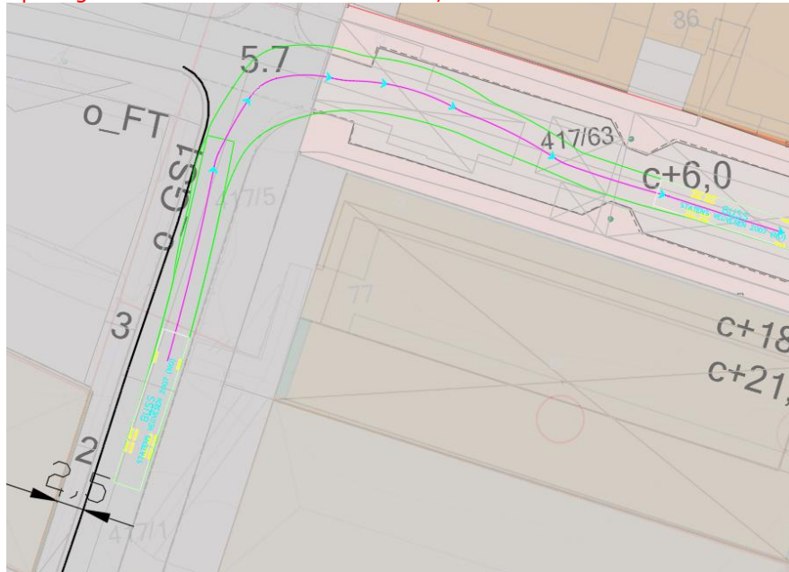
Sporingskurve med fortausutvidelse til 2,5 m:
