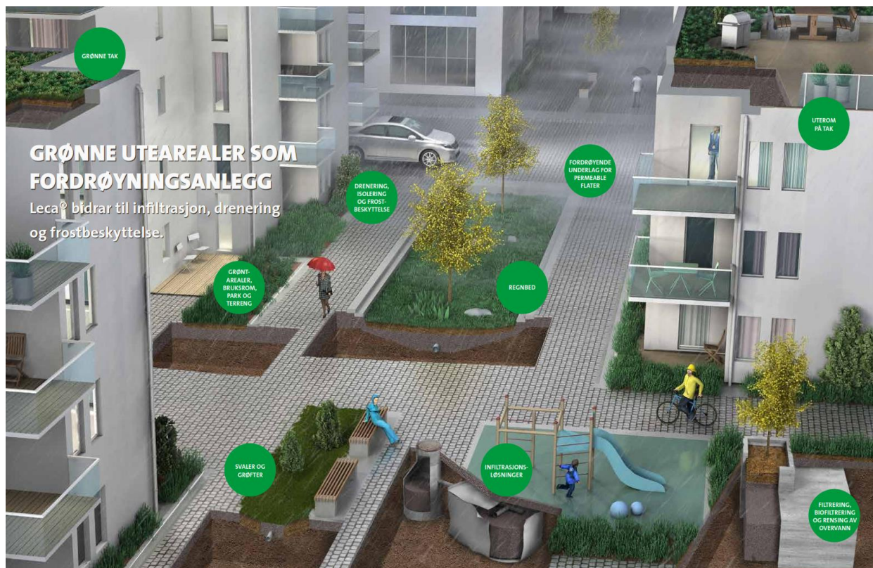
Figur 12 Fordrøyningsanlegg Hentet fra: https://leca.no/leca-i-gronne-tak , 30.06.2020
