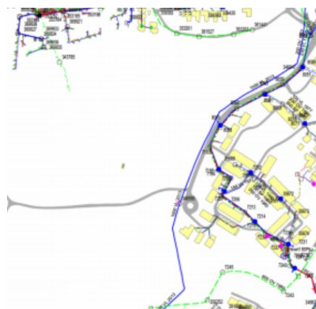
Figur 8 Vannledninger i Skjetleinskogen (veg).
