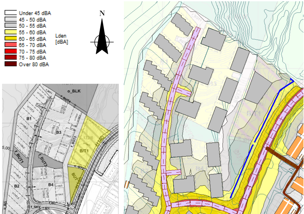
Figur 7: Beregnet lydnivå ( L_{den} ) i 1,5 meters høyde over terreng. Skjermingstiltak med høyde 1,2 m er vist med blå strek. Ikke i målestokk.
