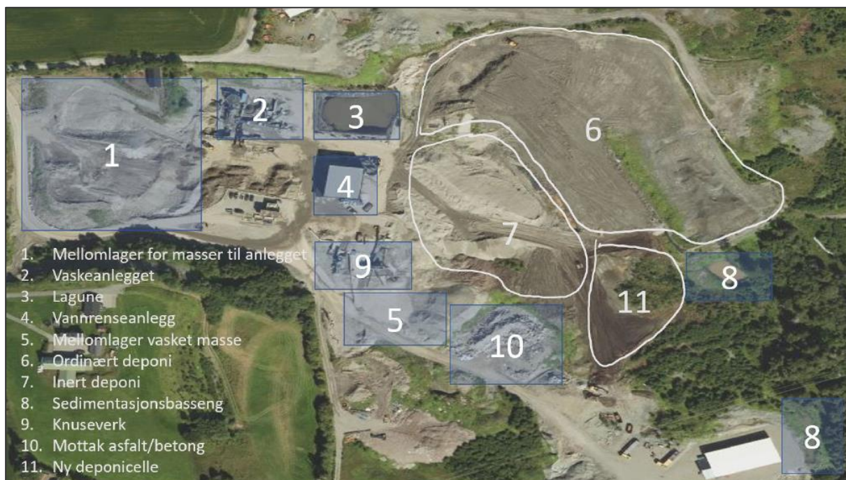
Figur 2 – Situasjonsplan overvannshåndtering (Miljørapport)
