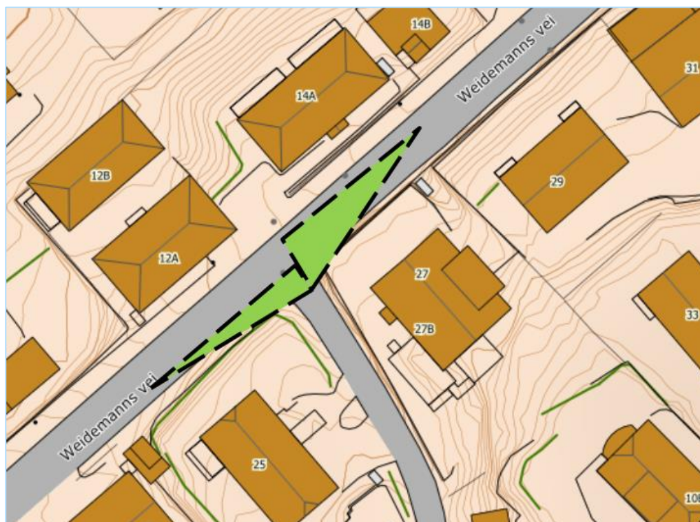
Figur 29 Siktkrav i situasjon ved forkjøringsregulert kryss i Weidemanns vei X Sigurd Bergs allé
