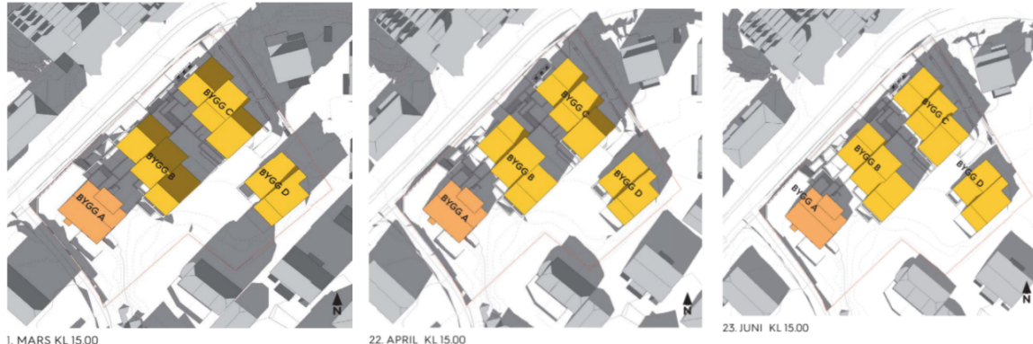
Sol- og skyggediagram av ny foreslått ny bebyggelse. Se flere sol- og skyggediagram på side 23 til 26 i illustrasjonsvedlegget .
