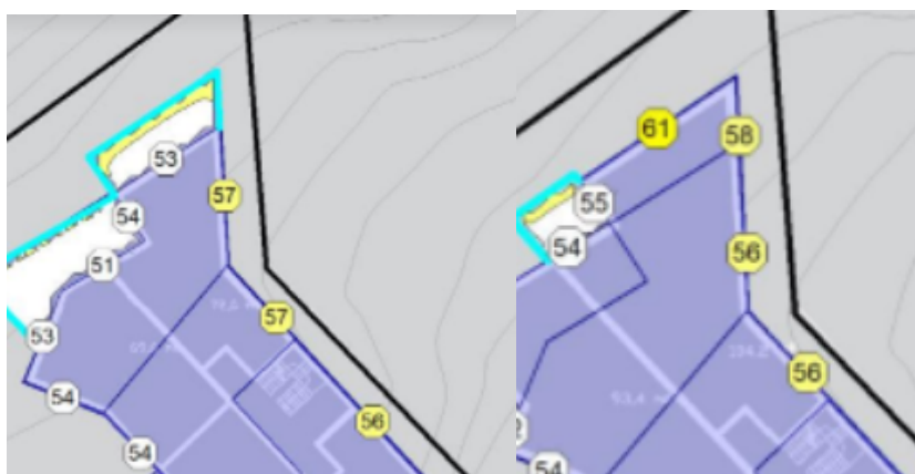
Støynivå på fasade på 3. etasje til venstre og 4. etasje til høyre.
