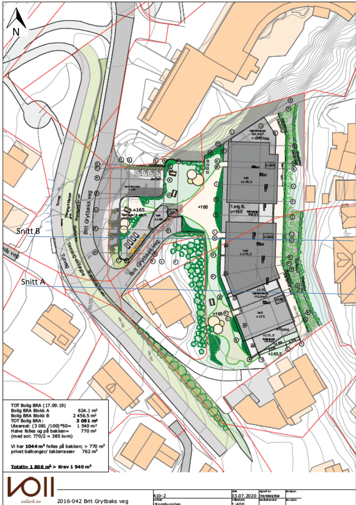
Figur 2: Plantegning som viser planlagte bygg [1].
