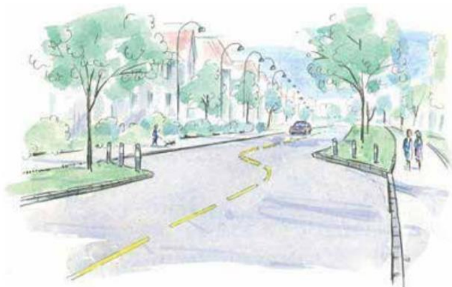
Figur 15: Sideforskyvning av 2-feltsveg. Håndbok V128
