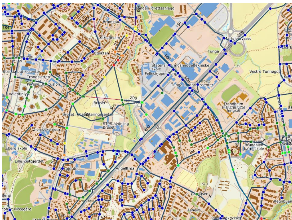
Figur 6: Trykkforhold med et brannvannsuttak på 58 l/s fra kum 2785. Rødt: mintrykk under 20 mVs, orange: mintrykk 20 – 25 mVs, gult: mintrykk 25 – 30 mVs, lysegrønt: mintrykk 30 – 40 mVs, mørkegrønt: mintrykk 40 – 50 mVs, blått: trykk over 50 mVs.
