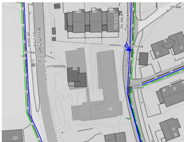
Figur 10 Utsnitt av ledningskart for vann og avløp
