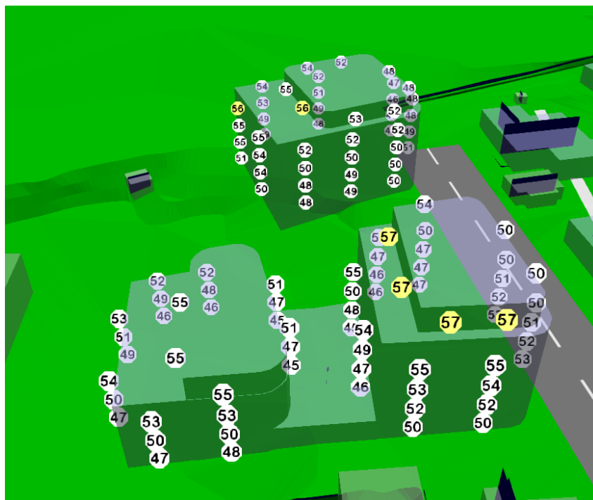
Figur 2 Beregnet støynivå, L_{den} , fra veitrafikk på fasader. Utklippet er hentet fra beregningsmodell
