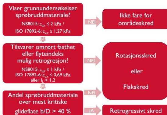
Figur 7: Flytskjema for vurdering av aktuell skredmekanisme, utsnitt fra ref. /3/.
