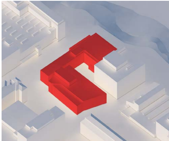
Bygningsmasse som rives
