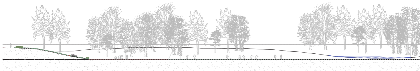
Snitt med geotekniske sikringstiltak (motfylling) trinn 1 - knyttet til Humsam
