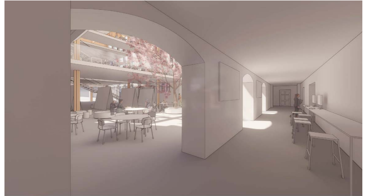
Fra eksisterende korridor i sokkeletasjen, der eksisterende brystninger i vinduspartier rives og erstattes av nivåfrie åpninger til nytt atrium
