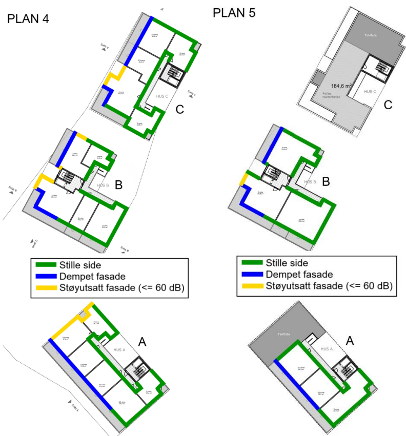
Figur 5: Planskisser som viser stille side, dempet fasade eller støyutsatt fasade for de ulike leilighetene
