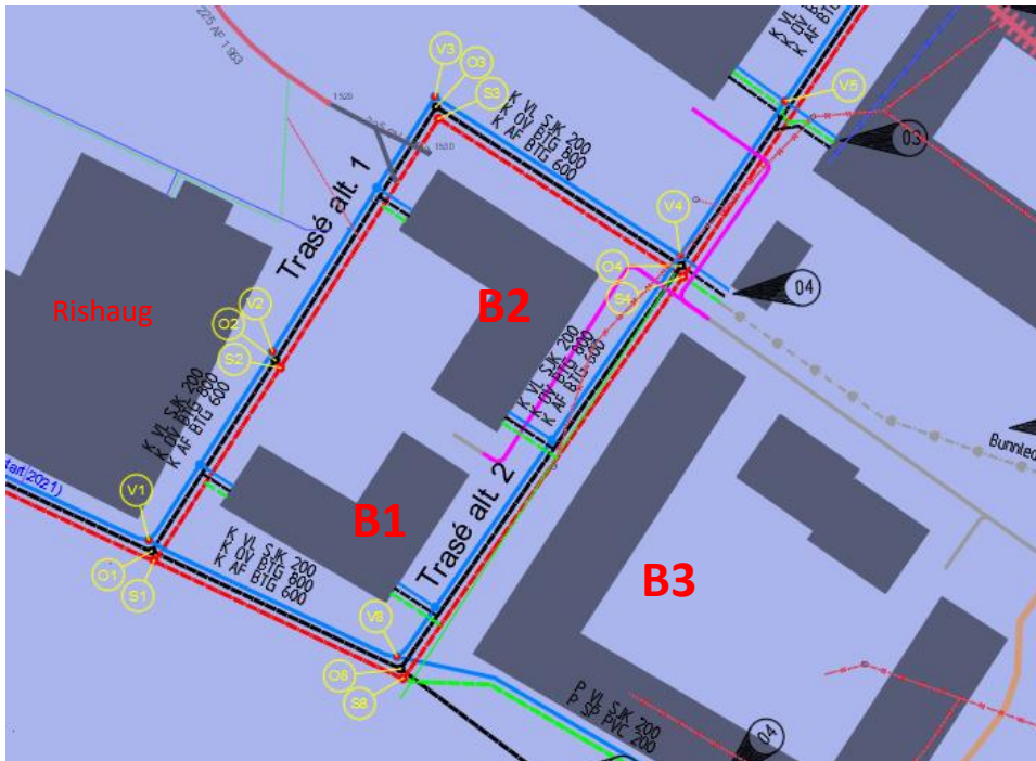
Figur 4-11 Utsnitt fra VA-plan: to alternative traséer for VA
