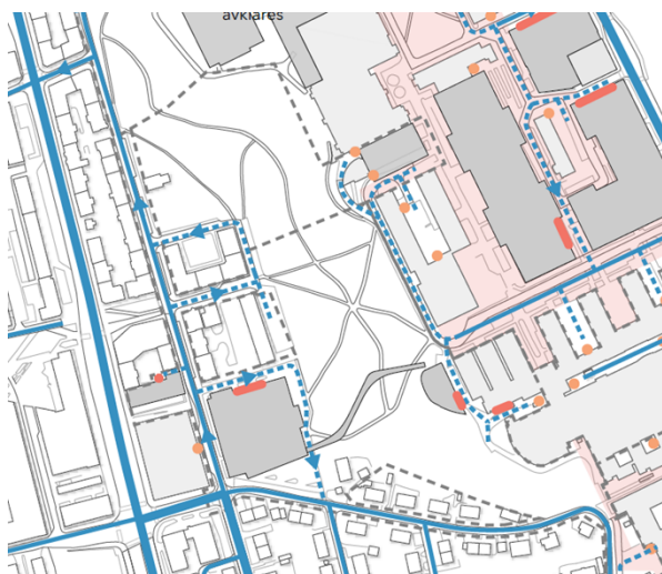
Kjøremønster - eksisterende varelevering er vist med oransje prikk. Fremtidig varelevering er vist med rød strek. Blå strek viser kjørevei/ kjøreadkomst. Stiplet blå strek er redusert trafikk.
