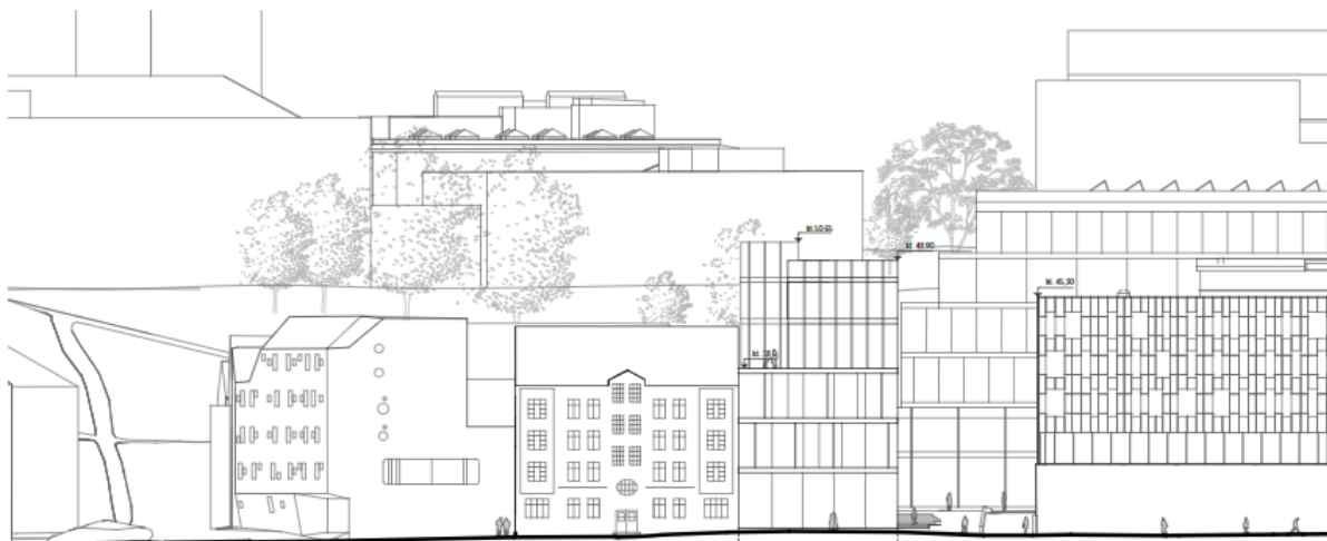
Figur 22. Oppriss fra vest (Elgesetergate) vist i massivtrekonstruksjon som gir en total høyde på 48.9 m. Opprisset nedenfor er vist fra øst (Klæbuveien).
