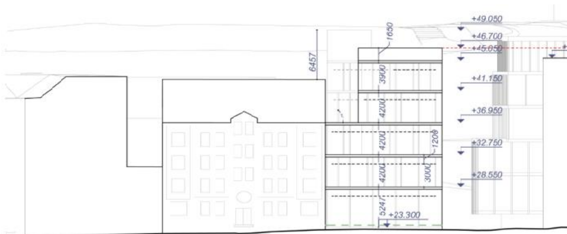
Figur 23. Oppriss og snitt fra Elgesetergate vist i tradisjonell byggemetode med stål/betongløsning med total byggehøyde på kote + 46,7 m.
