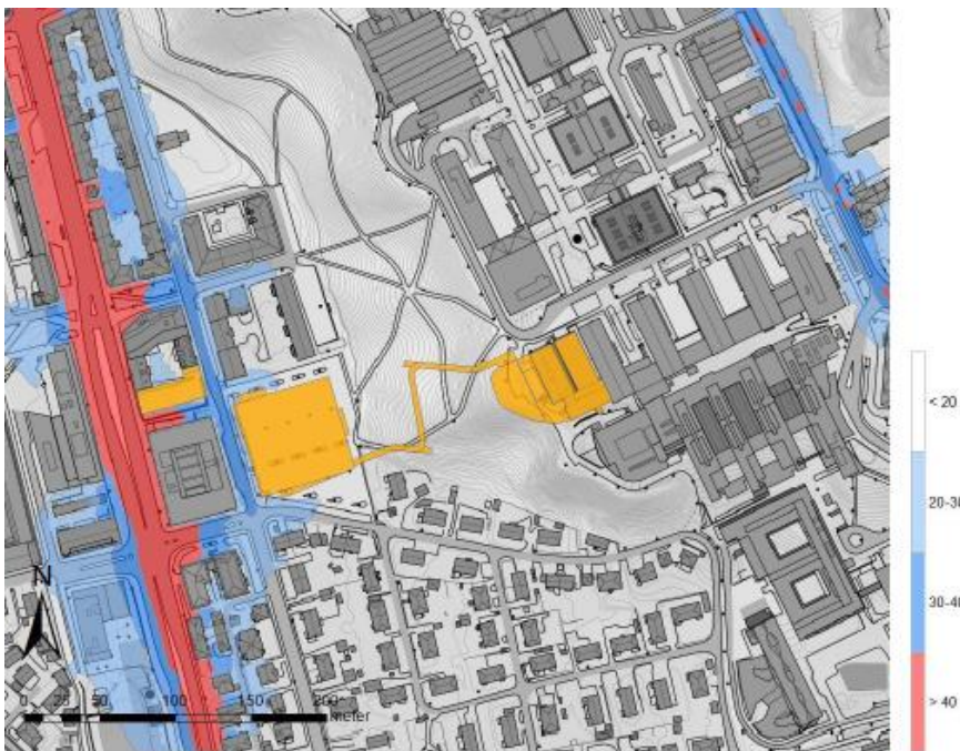
Figur 56 Luftsonekart som viser modellerte konsentrasjoner av svevestøv (PM 10 ) som 8. høyeste døgnmiddel for planforslaget. Gul og rød sone for PM 10 tilsvarer maks. 7 overskridelser av grensene på henholdsvis 35 og 50 µg/m 3 , iht. Retningslinje T-1520.
