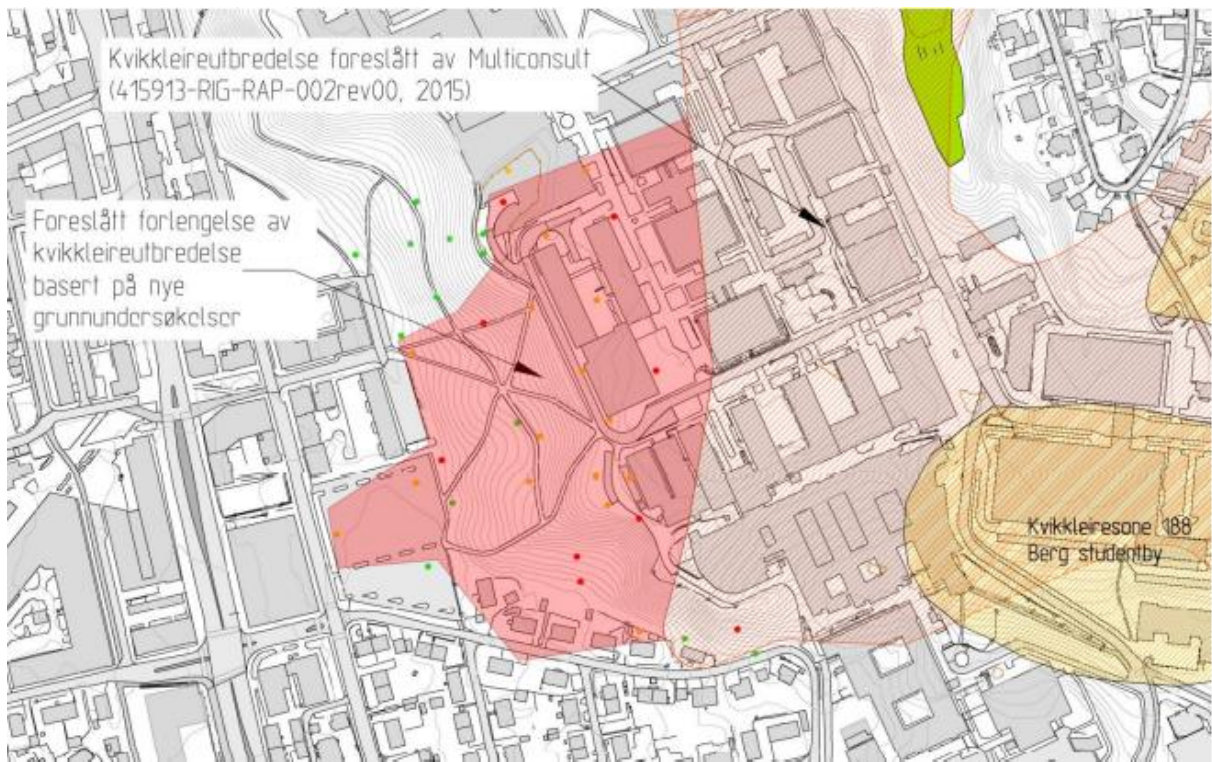
Figur 50 Foreslått forlengelse av kvikkleireutbredelse basert på nye grunnundersøkelser er markert i rødt på og ved planområde 2.
