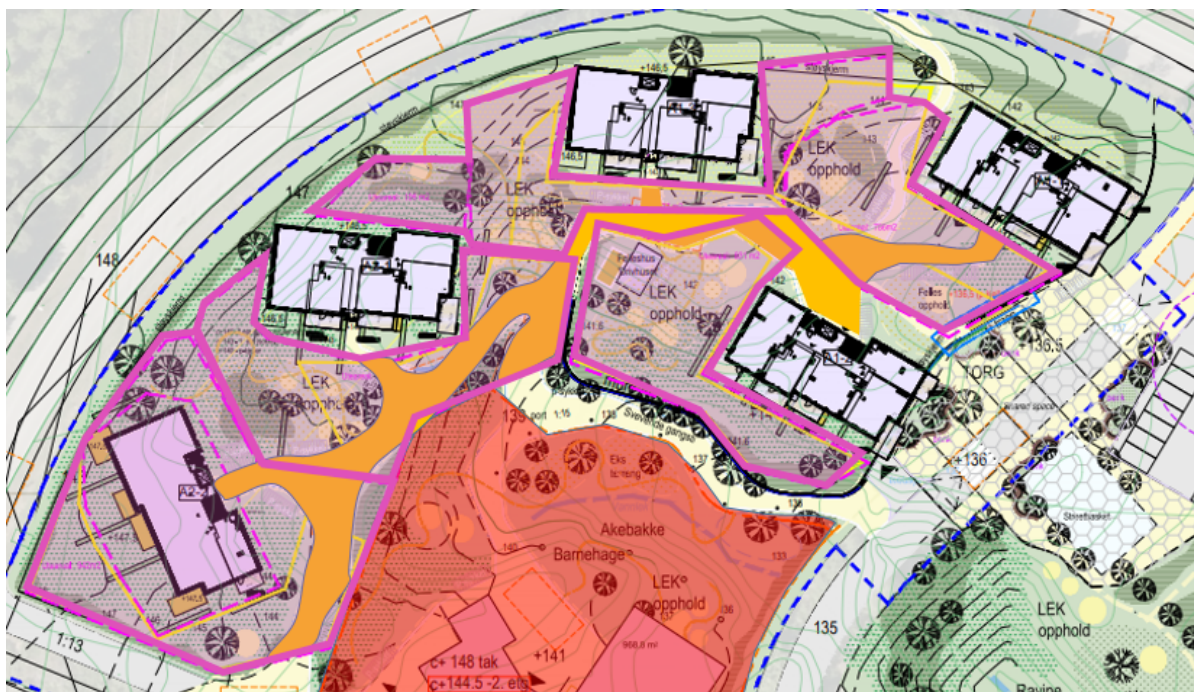
Figur 15 Felles uteareal som inngår i uteromsregnskapet markert med rosa. Kjørbare gangveger markert med oransje. Barnehagetomta er markert med rødt.
