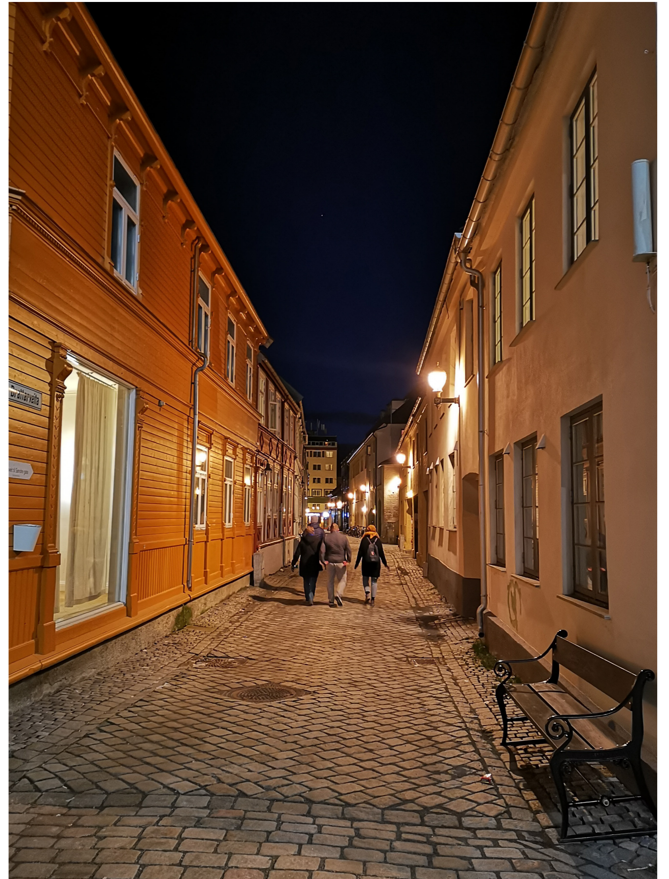
Brattørveita, Trondheim: Det er også jobbet med belysning av veitene for å bedre fremkommelighet og lesbarhet. Prosjektet har gjennomført en pilot med ny LED-innsats i historiske Trolla-armatur. Løsningen gir en svært god detaljgengivelse og øker fremkommelighet for svaksynte og andre brukere av veita. Steinsatt i 1997, lyssatt i 2019.
