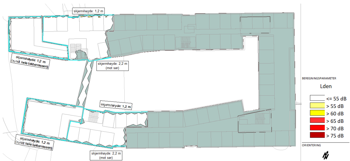
Figur 14 - Støy, L_{den} , i høyde for utendørs oppholdsareal (1,5 meter over takterrassegulv) med skjermingstiltak. Refleksjoner fra trapperom er ikke medtatt. Planlagt bebyggelse på Nardovegen 12 og 14 er inkludert i beregningene. Utklipp fra vedlagte tegning X004.
