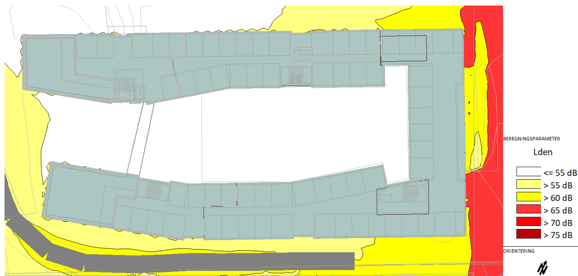
Figur 6 - Støy, L_{den} , i høyde for utendørs oppholdsareal (1,5 meter over terreng). Utklipp fra vedlagte tegning X001.
