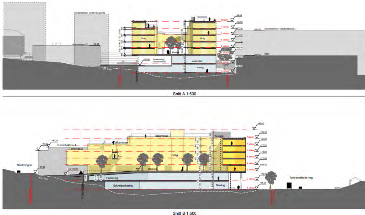
Figur 4-3 Opprisset øverst viser situasjonen ut mot Nardovegen med innsyn i gårdsrommet. Opprisset nederst viser lengdesnitt av bygningen med den høyeste delen i 7 etasjer ut mot Torbjørn Bratts veg t.h. (Plan Arkitekter 10.11. -21).
